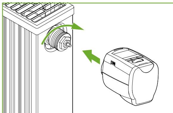
3. Sparmatic Comet namestite na radiotor in zasučite spojno matico v smeri urinega kazalca.
