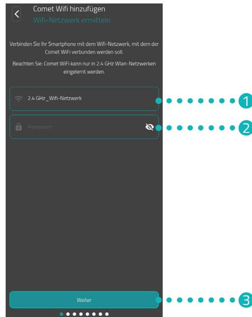
1. Es wird automatisch das WLAN-Netzwerk angezeigt, mit welchem Ihr Smartphone verbunden ist. Sie können Ihren CZW-250 bei Bedarf in ein anderes WLAN-Netzwerk einbinden.
