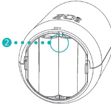
1. Öffnen Sie die Batteriefachabdeckung.
