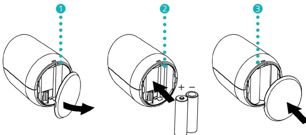
1. Öffnen Sie die Batteriefachabdeckung.
