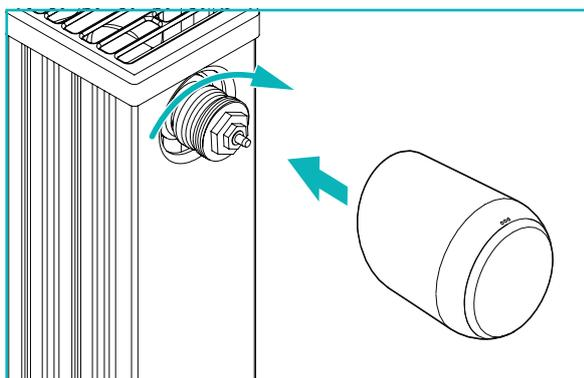
3. Stecken Sie Ihren CZW-250 auf den Heizkörper und drehen Sie die Überwurfmutter im Uhrzeigersinn.
