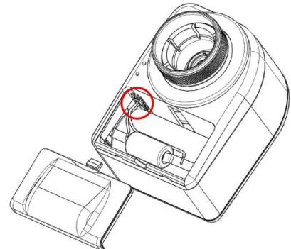
Der Stella Pro EnOcean wird mit einer Lithium-Batterie (3,6 V, C-Zelle) betrieben. Diese ist mit einem High Load Connector (HLC) ausgestattet.
