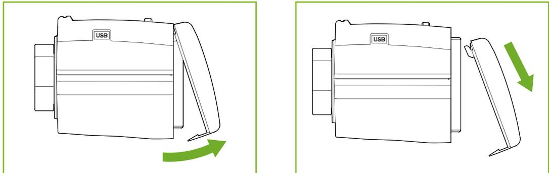
1. Spingere in alto il coperchio del vano batterie e rimuovere il coperchio dal vano batterie.
