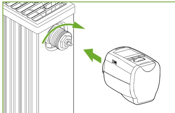
3. Infilare lo Sparmatic Comet sul radiatore e girare il dado per raccordo in senso orario.
