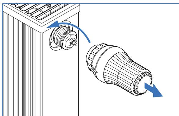
1. Aprire completamente la testa termostatica attualmente montata.
