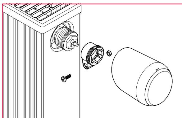
3. Opzionalmente: scegliere un adattatore compatibile fra quelli forniti in dotazione. Per ulteriori informazioni sugli adattatori si veda
